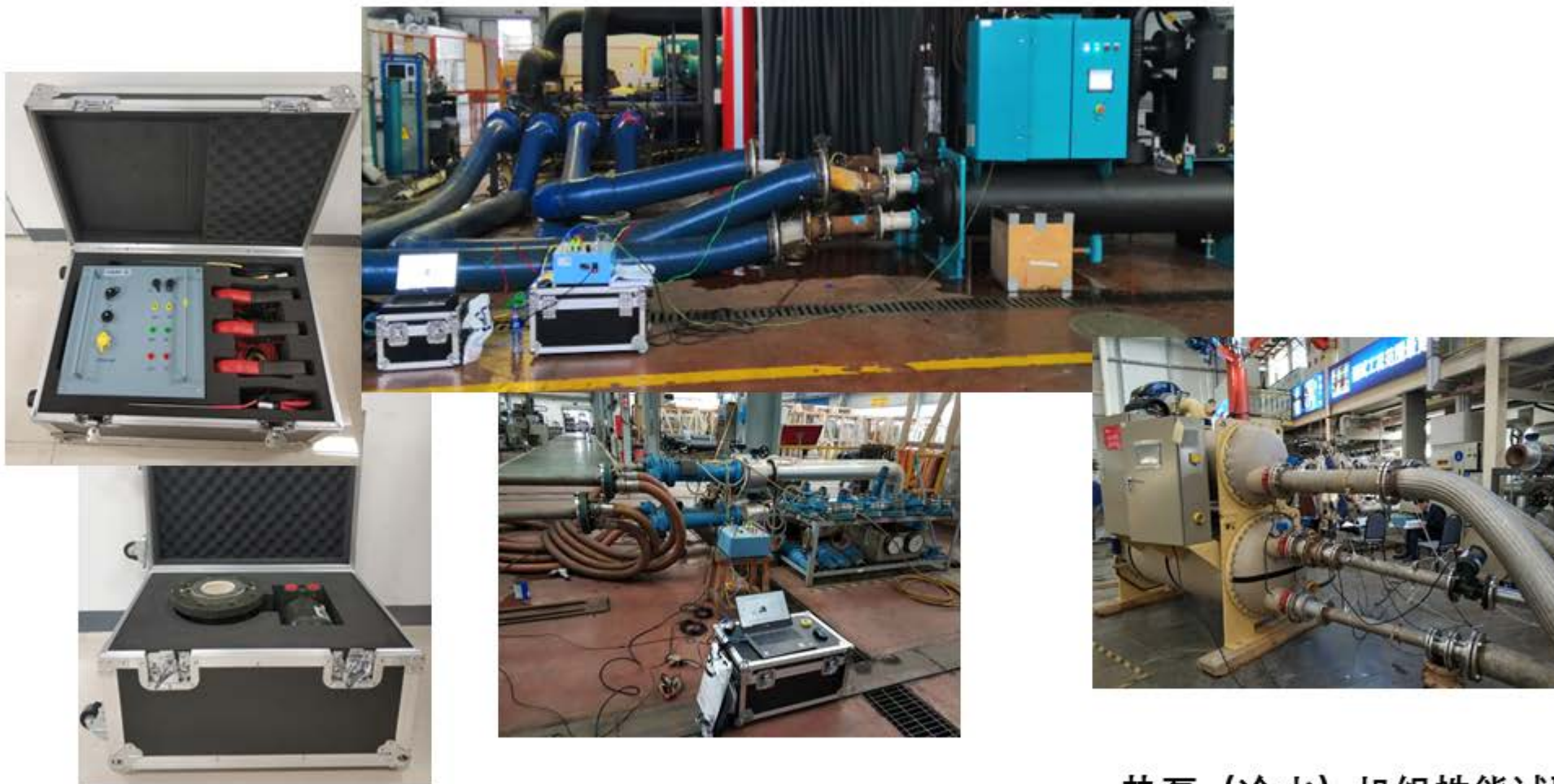
热泵（冷水）机组性能试验
